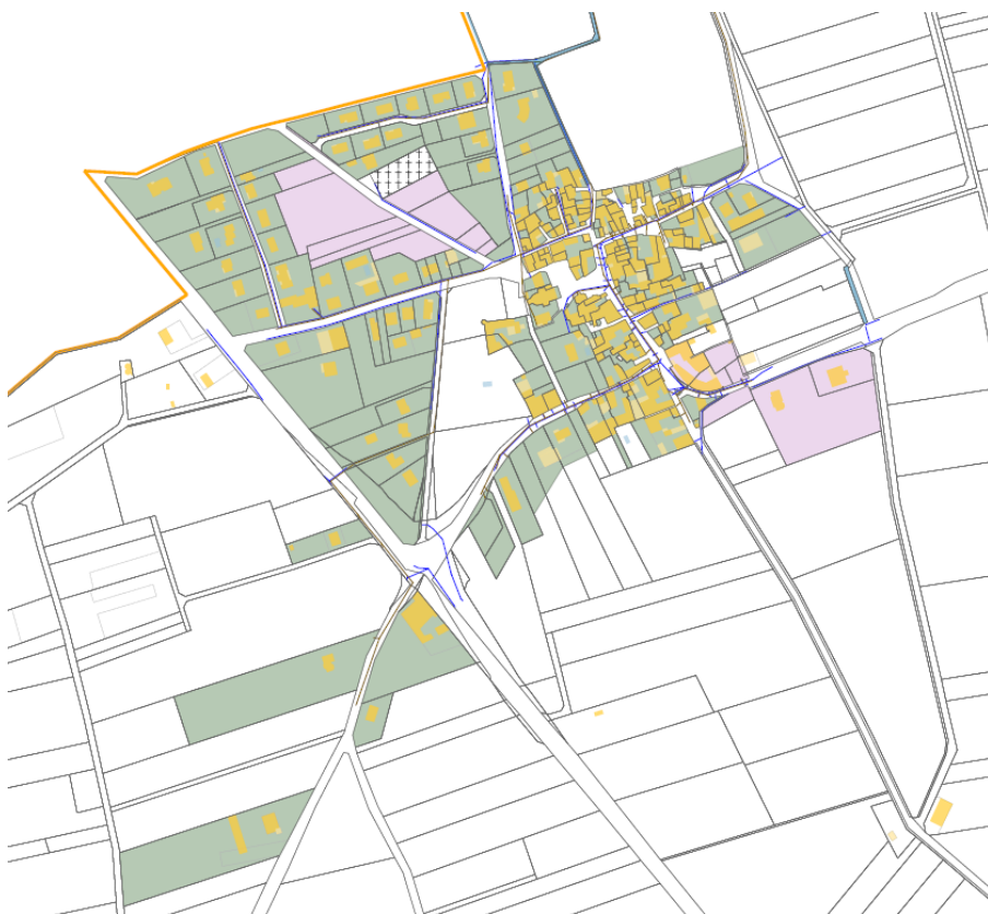
PLAN DU RESEAU D'EAU POTABLE (EN SOUS-TERRAIN)
